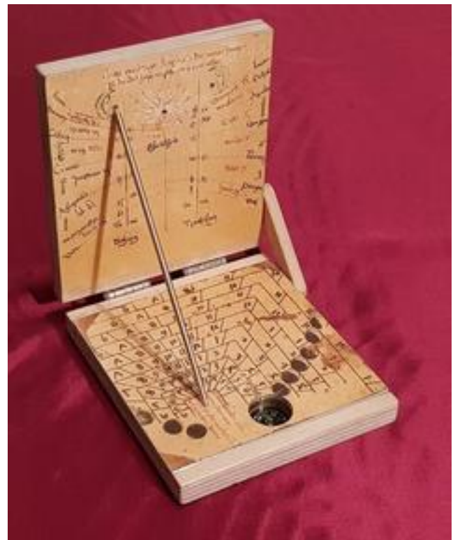
Abb. 1 Die Monduhr des Phebilabiums (Nachbau) mit dem Polstab und der dem Original nachgebildeten Skalenplatte für den zunehmenden Mond.
