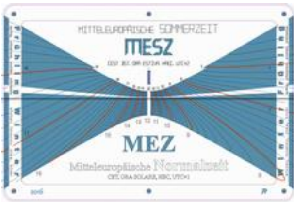
Abb. 5c Konstruktionszeichnung mit Sandstrahlmaske [GSA5233]: „Umschaltband“ für den Wechsel zwischen Normal- und Sommerzeit; „Zacken“ an der Linie für die Sommersonnenwende.
