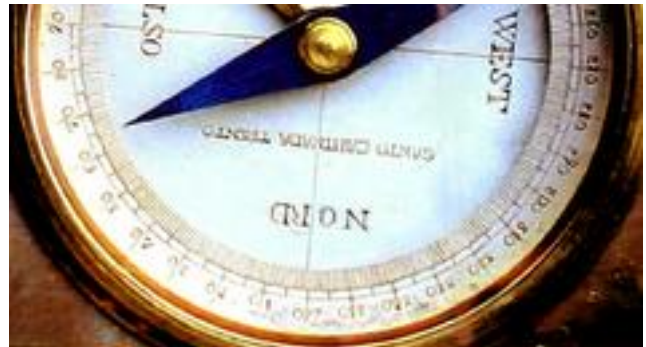
Abb. 5 Der von Santo Caminado in Trento stammende Kompass ist um die Missweisung von 4,7° O verdreht.
