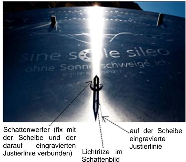
Abb. 2: Die Die Scheibe wird gedreht, bis die Justierlinie genau in der Mitte der Lichttritze zu liegen kommt
