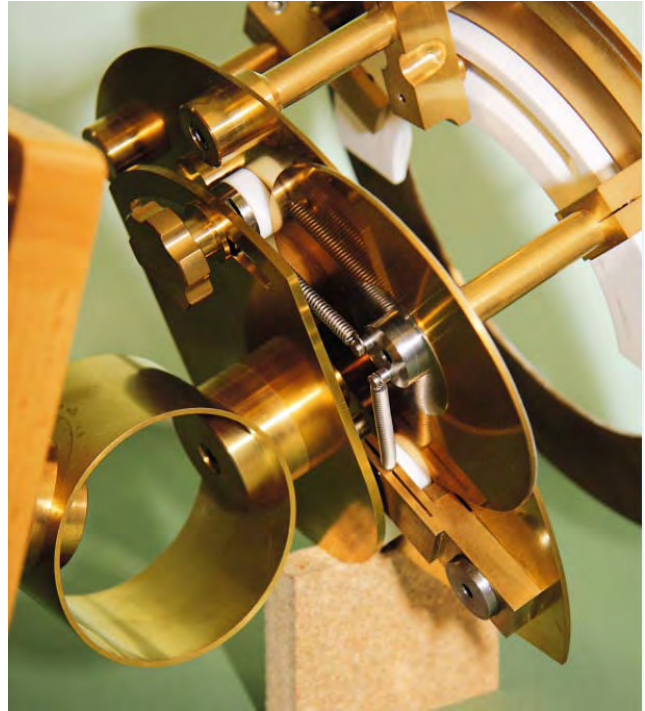
Abb. 4 Federn drücken die Nockenscheibe gegen die Anschlagrollen
