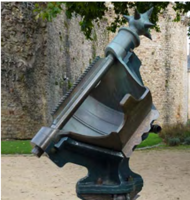
Abb. 3 Die Sonnenuhr von Bollée, ursprünglich für die Eisenbahn entworfen. Mit Einstellung der geographischen Breite und der Zeitgleichung
