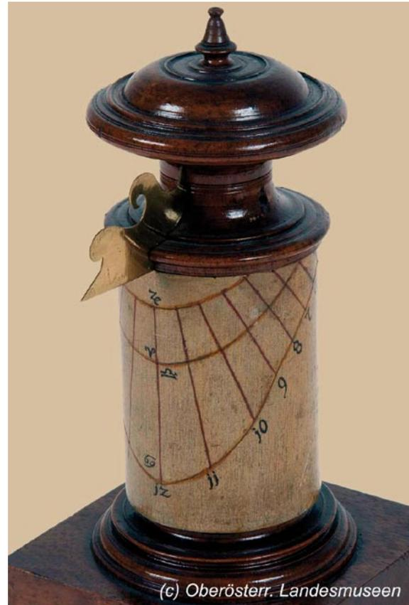
Abb. 2: Azimutale Höhensonnenuhr
