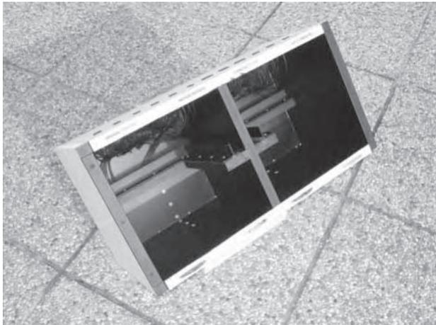
Abb. 2b: Leisten an Rück- und Zwischenwand mit den Lichtleiterenden zur Aufnahme des Lichtes
