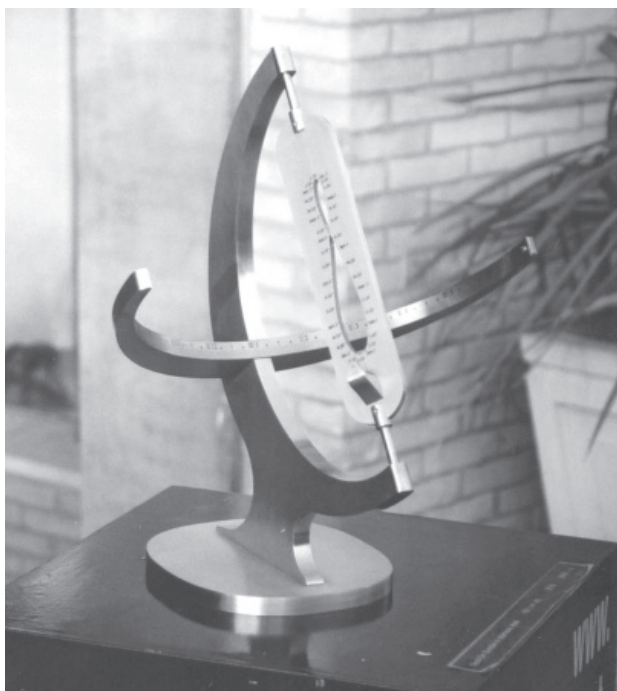
Abb. 4: Moderner Nachbau einer Mifflin-Uhr, Lochgnomon unter der Acht (Tony Moss)
