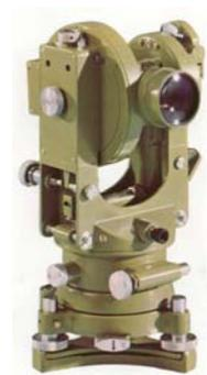
Der RDS von Wild ist ein klassischer Ingenieurtheodolit (=mittlere Genauigkeit), noch ohne Distanzmessung. Die Ablesung durch das Skalenmikroskop erlaubt Zentigon, Milligon könnten geschätzt werden.
