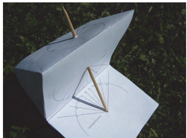
Abb. 2 Zeigerschatten auf einander schneidenden Ebenen Modell aus dem Unterricht von Nicolette Doblhoff (RS 43).
