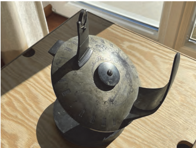
Abb. 1 Das noch nicht restaurierte Heliochronometer von Bénévolo & Coquais.
