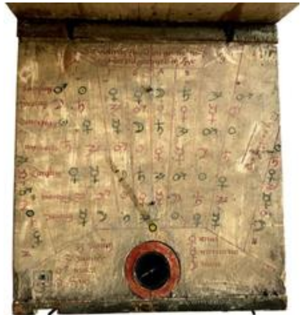
Abb. 8 Die Bodenplatte mit dem Kompass und der Skala für die Planetenstunden.
