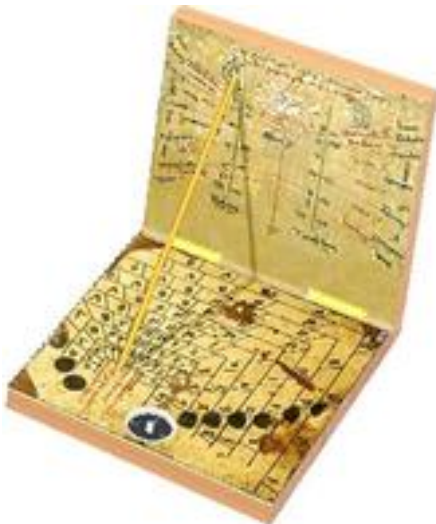
Abb. 10c Das Phebilabium als Monduhr mit langem Polstab.
