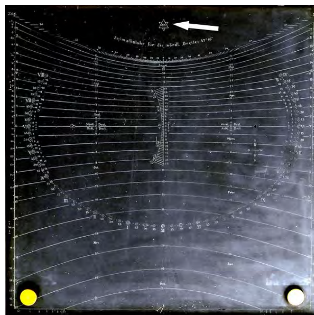
Abb. 4 Die Linien auf der Skalenplatte der Messmer-Uhr. Der Pfeil weist auf das Auge-Stern-Symbol.
