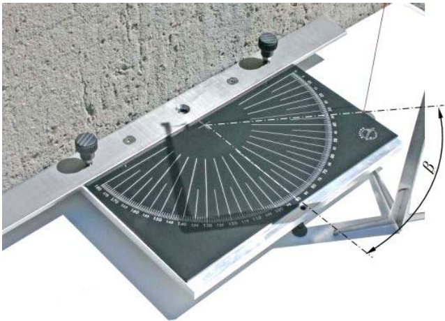
Abb. 2 Methode ähnlich (1), aber mit einem senkrechten Faden als Schattenwerfer. (Foto Carlo Heller)
