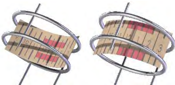
Abb. 1 Die französische Mittagspausen-Sonnenuhr. Links normal, rechts mit umgestülptem Skalenband
