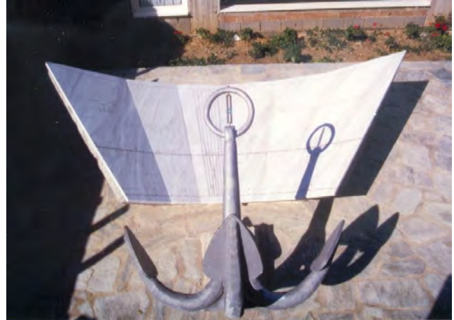
Abb. 3 Der Polstab mit Lochblende an der Ankeruhr auf Skiathos
