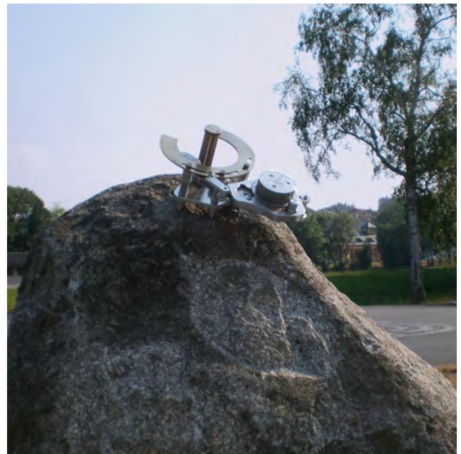
Abb. 20 Das Heliochronometer auf seinem Granitfindling. An der Achse ist der schmale Lichtspalt zu sehen, der die präzise Ablesung ermöglicht.
