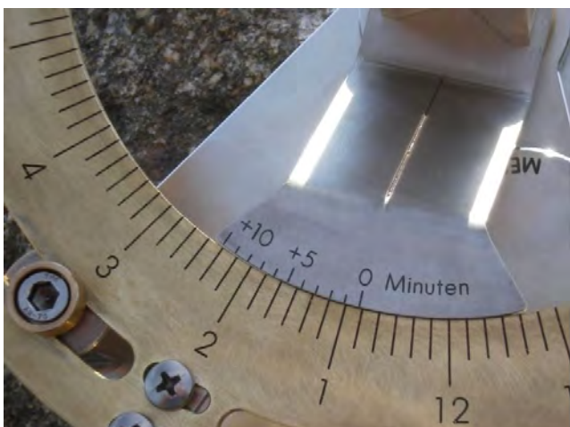
Abb. 15 Eine Zeitablesung an der Noniusskala des Drehzeigers: 12:50 Uhr plus 2 Minuten = 12:52 Uhr (hier im Februar bei negativer Sonnendeklination).
