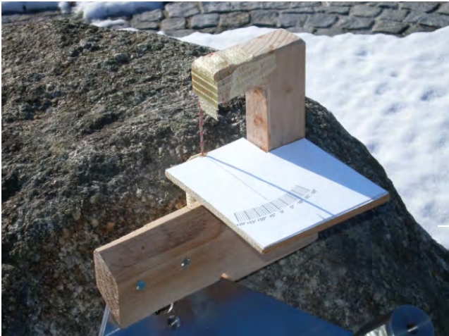
Abb. 6 Die Azimutpeilvorrichtung mit Lotfaden, mit der die Lage der drei Ankerbolzen bestimmt wurde.
