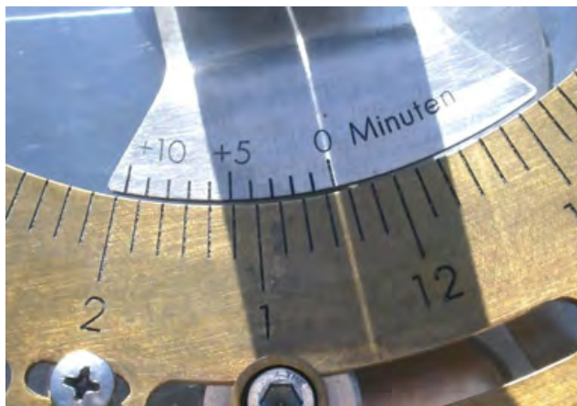
Abb. 16 Eine Zeitablesung „zwischen den Noniusstrichen“: 12:26:20 Uhr (hier bei positiver Sonnendeklination, der Lichtstrahl trifft die Skalenfläche).
