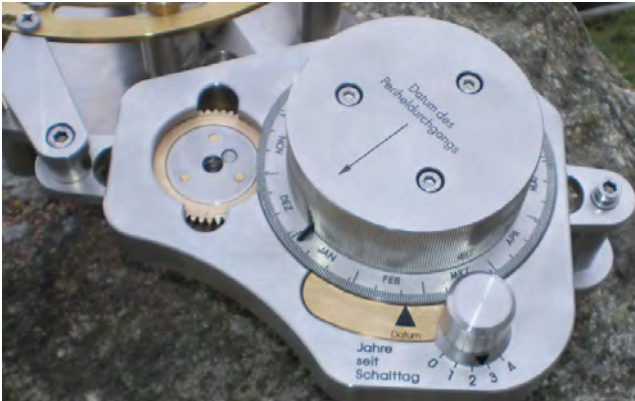
Abb. 9 Das Zeitgleichungsgetriebe. Ansicht von oben.
