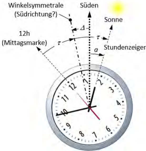
Abb. 2 Der Messfehler beim Analoguhr-Kompass. a Sonnenazimut \tau Stundenwinkel \Delta Messfehler \Delta = a - \tau
