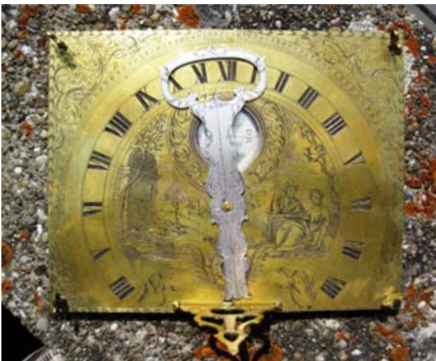
Abb. 1 Horizontale Minutensonnenuhr mit mechanischem Zeiger, signiert und datiert: „Franz Antoni Knitl / Fecit Linz 1720“; Standort: Sternwarte Kremsmünster
