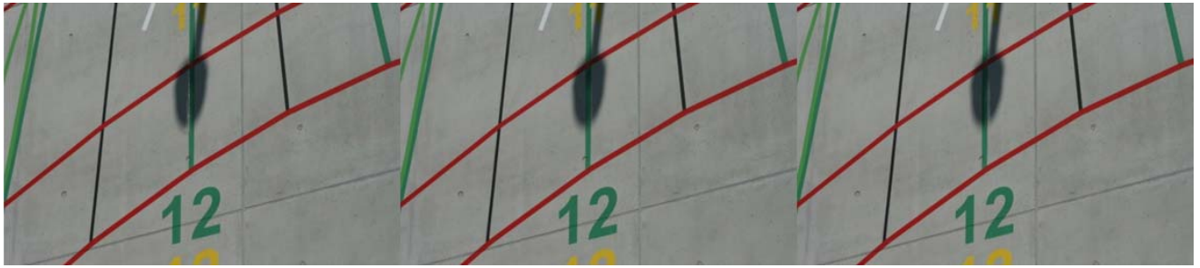
Abb. 4 Der Lichtspalt des Meridianschlitzes um 12h WOZ auf der Skalenlinie
