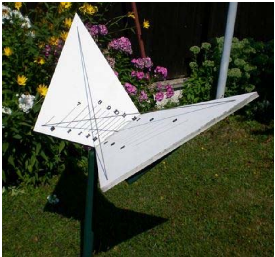
Abb. 2 Beispiel einer nicht konventionellen Bifilarsonnenuhr, realisiert von Hans Kolar, Gablitz.
