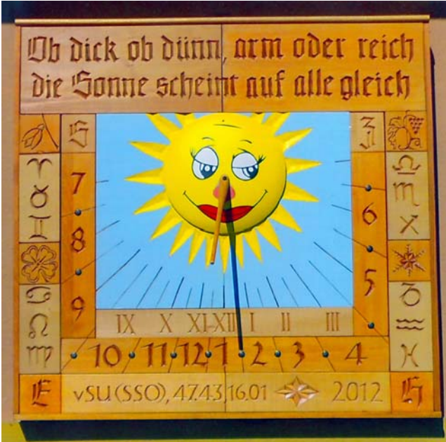
Abb. 2: Die fertige Vertikaluhr; \lambda = -16^{\circ}01' , \varphi = 47^{\circ}43' , Südabweichung 4^{\circ} Ost
