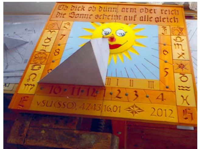
Abb. 6: Justieren des Zeigers entlang einer Kante des Pyramidenstumpfes. Der schief abgeschnittene Zeiger sitzt auf der Sonnenscheibe auf und wird mit einer Schraube fixiert.
