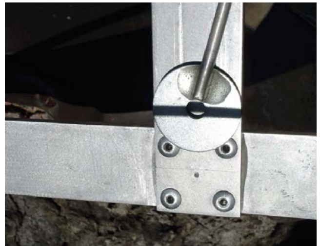
Abb. 4: Umbra demonstrat: Der Schatten des Bogenstücks fällt auf die Mitte der Kreisscheibe
