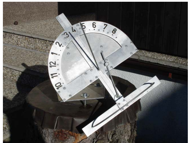
Abb. 3: Die Sonnenuhr mit dem Deklinationkompensator von oben
