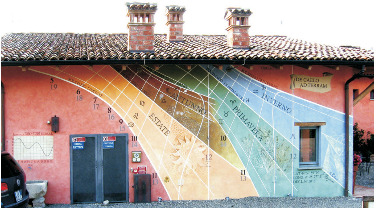
Abb. 5: Sonnenuhr in Terravera. Die Zifferblätter für je zwei Jahreszeiten ermöglichen es, die Achterschleife für 12 Uhr MEZ zu teilen. Die „Anzeiger“, die Spiegel mit ihren Halterungen, sind an den Enden der beiden nach oben abgewinkelten Stäbe befestigt.
