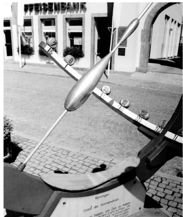
Abb. 2: Stundenmarken, unten die gebogene Tafel mit der Anleitung zum Ablesen
