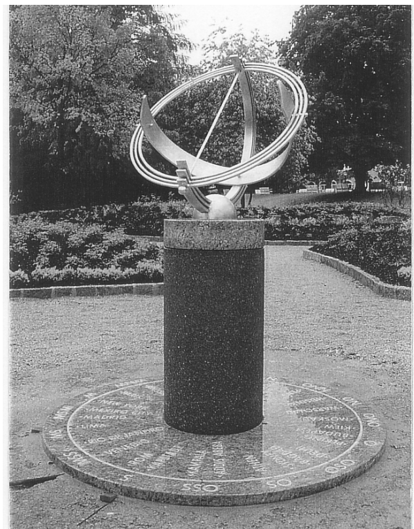
Abb.4: Äquatoriale Sonnenuhr im Kurpark in Bad Hofgastein (S) und. Himmelsrichtungen einiger Weltorte; Korrekturtabelle; Material: Messing und Granit; Konstrukteur: G. Krondorfer
